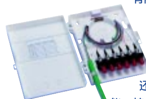
这些模块是为了用于 USOI™ 墙板系统内部而设计的，分成 25x50mm 和 50x50mm 平直正面型和 50x50mm 斜面型，保证了正确的弯曲半径。可以从正面迅速组装墙板，墙板可以容纳 ST、SC、MT-RJ 和 FDDI 光纤适配器。
